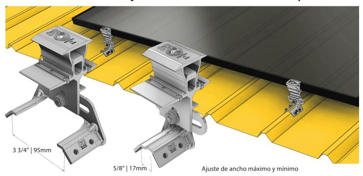
El Protea PV cuenta con dientes de unión que garantizan una unión eléctrica acorde a la UL 2703. La unión y la conexión a tierra se convierten en una tarea sencilla con el Protea PV, ya que cada accesorio garantiza la conexión de módulos y su conexión a tierra a lo largo de la columna de los paneles FV. Simplemente conecte cada columna de módulos para crear un arreglo fotovoltaico completamente conectado a tierra con nuestro puente de unión (se vende por separado).
