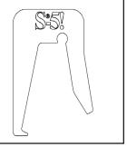
Inserto con bisagra (Reversible para adaptarse a diferentes anchos de junta)
